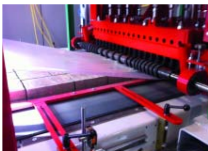
Необработанные изделия на входе в установку для состаривания, специальная пленка защищает поверхность изделий
