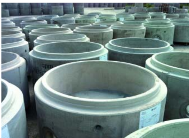
Монолитные кольца с дном Perfect подготовлены к погрузке на заводе компании CPM, Стаффордшир
