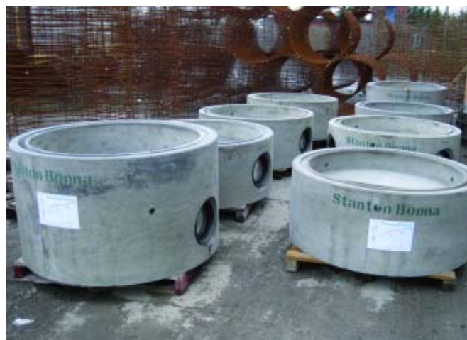
Сразу после распаковки кольца с дном устанавливаются на поддоны
