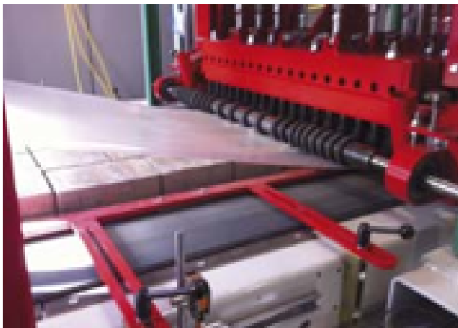
Surowe wyroby betonowe u wlotu linii postarzania, folia chroni powierzchnię wyrobów przed uszkodzeniem podczas postarzania.
