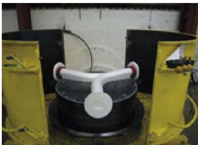
Modele styropianowe umieszczane są w stalowych formach i zalewane betonem samozagęszczalnym.
