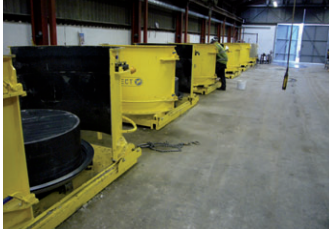
In una sezione del capannone adattata il gruppo CPM produce fondi pozzetto monolitici Perfect
