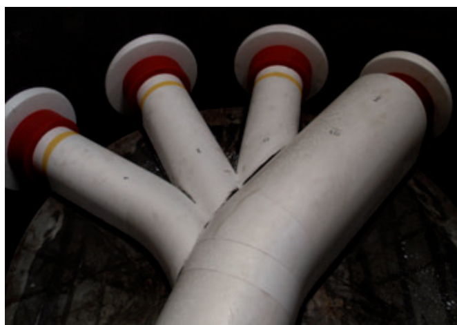
Alla libertà di progettazione degli ingegneri non è posto alcun limite - tutti gli stampi negativi per i canali di scolo possono essere adattati singolarmente
