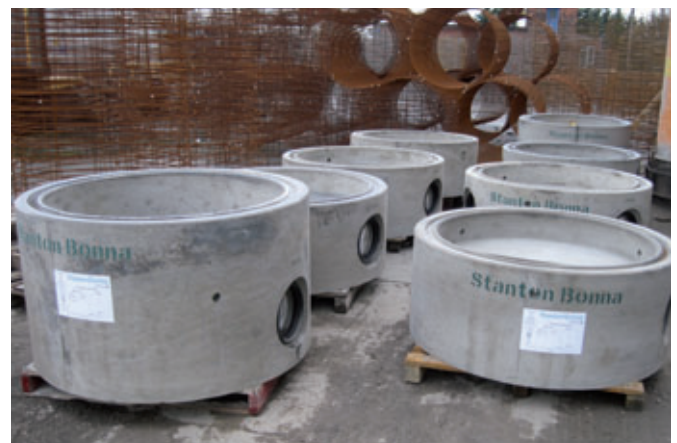
Subito dopo la disarmatura, alla Stanton Bonna i fondi pozzetto vengono collocati su bancali
