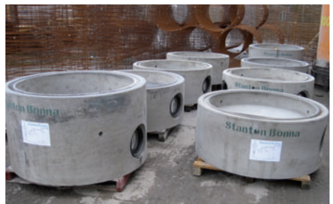
Chez Stanton Bonna les fonds de regard sont mis sur palette immédiatement après le décoffrage
