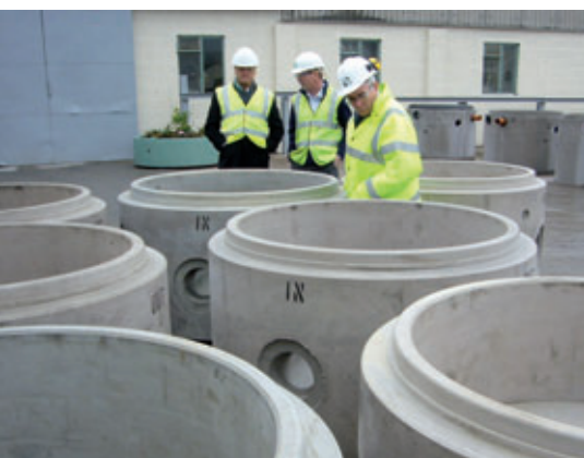
De nombreuses entreprises de construction ainsi que des clients intéressés par cette nouvelle technologie viennent s'informer chez CPM sur les avantages de ces fonds de regard très précis réalisés en démolage différé.
