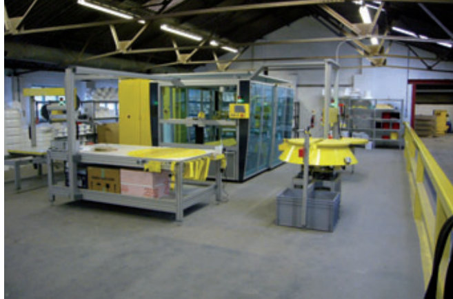
La technologie des scies à fil chaud permet de mettre en place des procédures simples pour la fabrication de fonds de regard sur mesure
