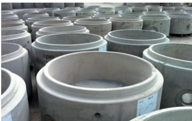
Fonds de regard Perfect en attente dans la zone de chargement de CPM, Staffordshire
