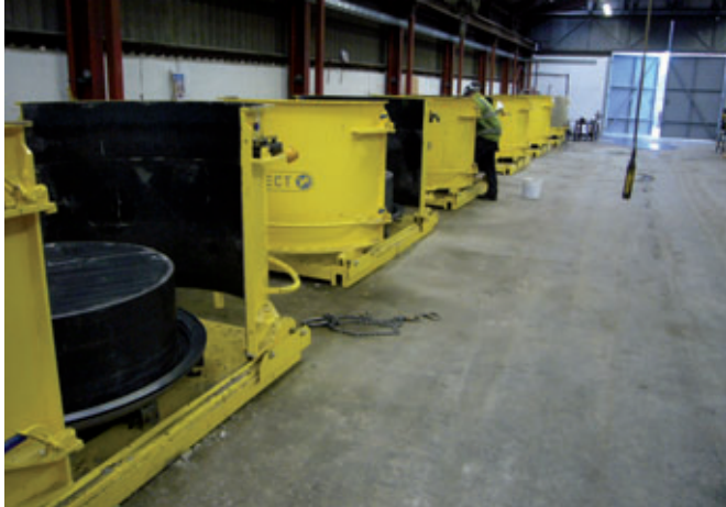
In einem adaptierten Hallenabschnitt produziert CPM monolithische Perfect-Schachtunterteile
