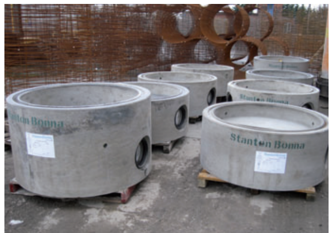
Bereits nach dem Entschalen werden die Schachtunterteile bei Stanton Bonna auf Paletten gestellt
