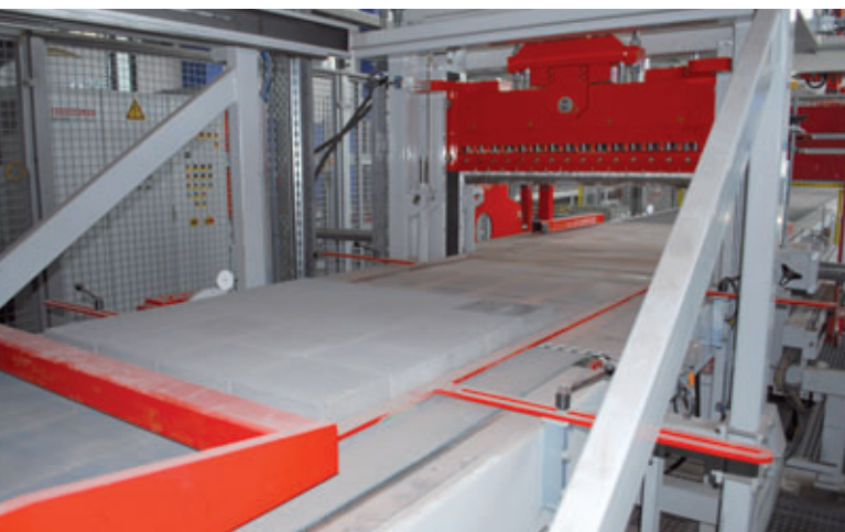
Die Lage wird reihenweise unter die Spaltmaschine geschoben
