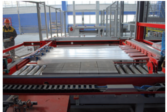
Zwischenlagenspender mit Folie als Medium
