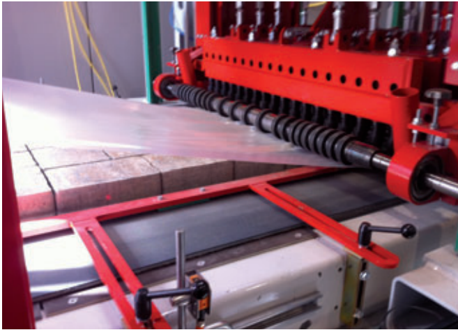
Unbehandelte Produkte am Einlauf in die Alterungsanlage, die mitlaufende Folie schützt die Produktoberflächen vor Beschädigungen während des Alterns.
