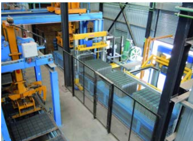
Обратная транспортировка с 4-сторонним центрированием и транспортировка пакетов
