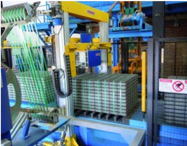
Балочный транспортер и станция оборачивания пленкой
