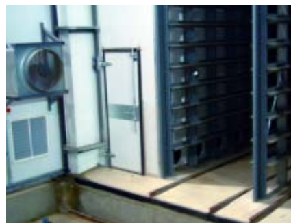
Система циркуляции воздуха для оптимального твердения изделий
