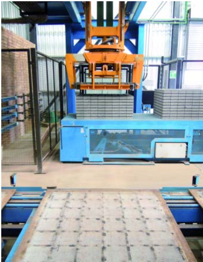
Пакетирование с помощью захвата с сервоприводом
