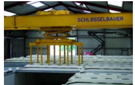
За счет вращения захватов возможно перемещение крышек сушильных камер без замены инструмента
