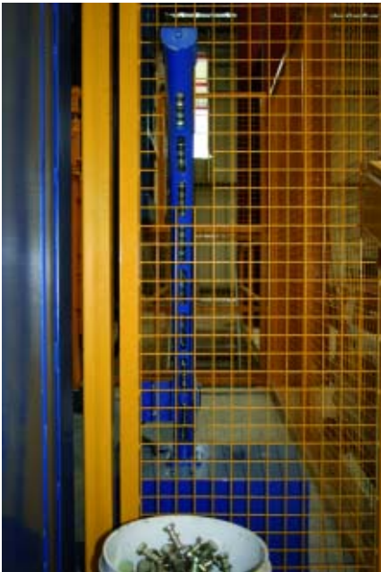
Новинка при производстве сборных бетонных элементов: магазин транспортных анкеров с 25 анкерами на каждую сторону монтажа
