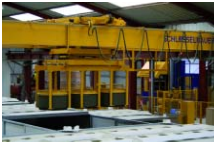
Закладка свежих шахтных колец в сушильные камеры
