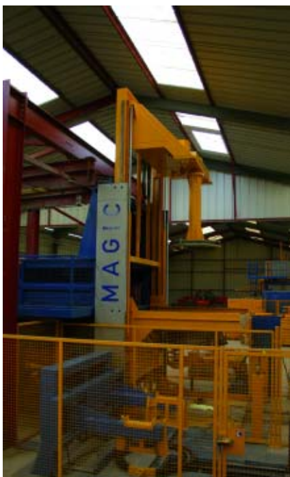
Новая производственная установка Magic 1501 на заводе сборных бетонных элементов компании Vonna Sabla в городе Бруз
