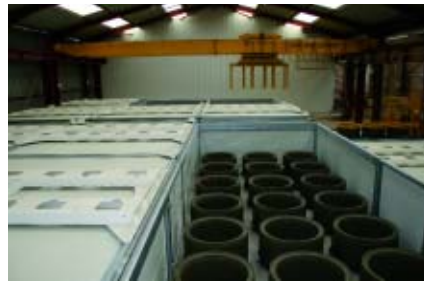
Шахтные кольца после сушки перед транспортировкой краном-роботом
