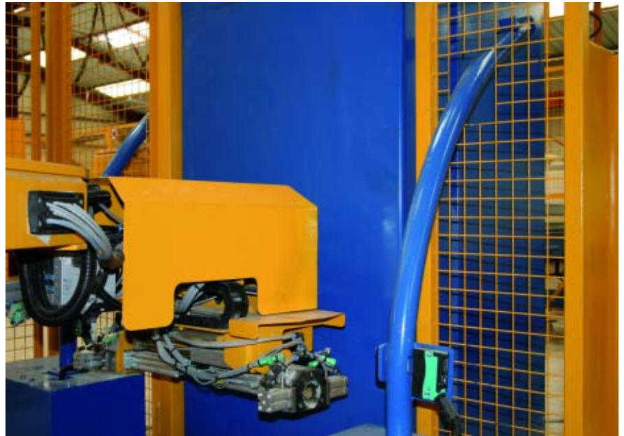
Робот для заформовывания анкеров автоматически захватывает два анкера и размещает их в шахтном кольце
