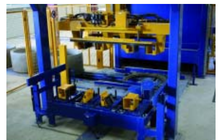
Новинка компании Schlüsselbauer: узел быстрой смены инструмента для захватов
