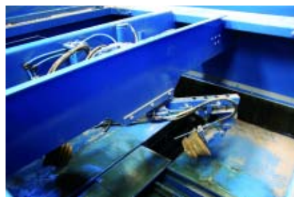
Губки для смазки поддонов эффективно наносят смазку
