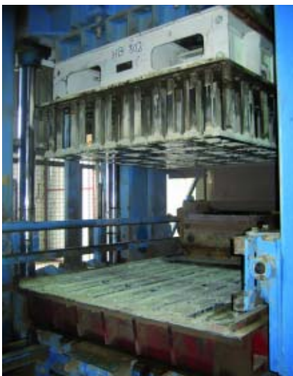
Компания Foresight Cement Industries L.L.C. производит 8-дюймовые пустотные блоки на установке MASA XL 9.2
