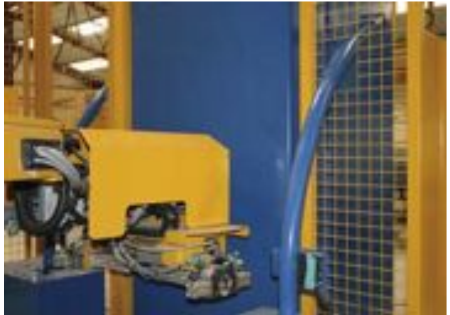
Robot pobiera automatycznie po 2 kotwy i osadza je w kręgu betonowych.
