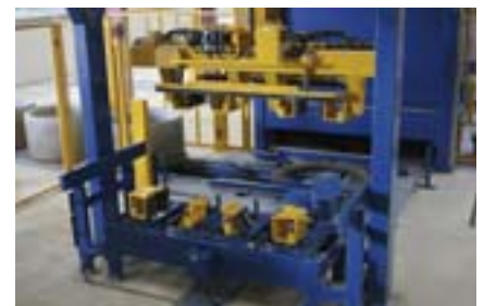
Nowe rozwiązanie firmy Schlüsselbauer: szybko wymienny podzespół chwytaka.
