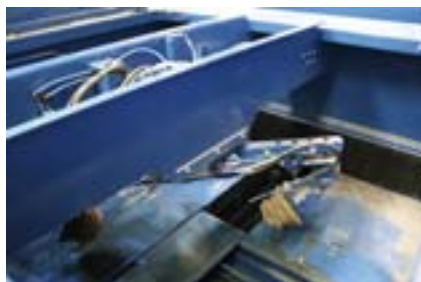
Walce gąbczaste nakładają ciekłą warstwę oleju na pierścienie dolne.
