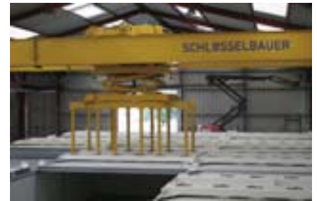
Obrót ramion chwytaka pozwala na transport pokryw komór bez konieczności zmiany wyposażenia.
