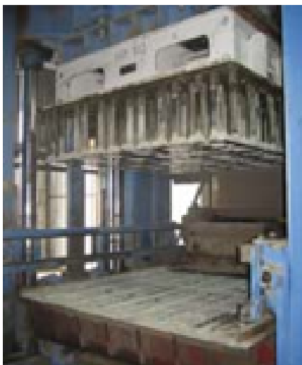
Firma Foresight Cement Industries L.L.C. produkuje 8-calowe pustaki za pomocą wibroprasy Masa XL 9.2.
