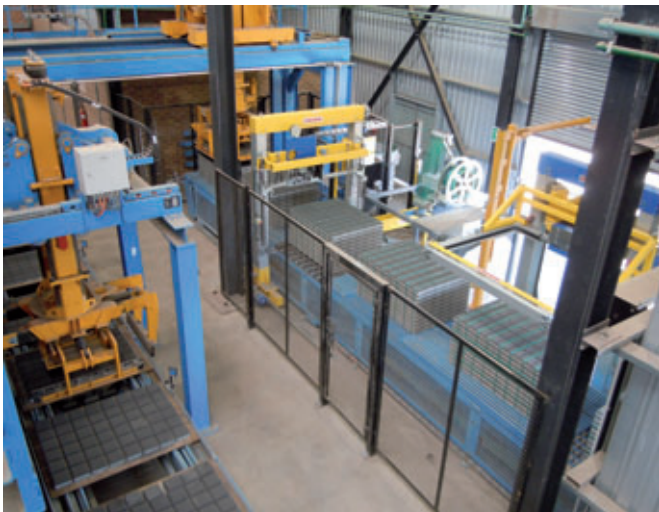
Trasporto di ritorno con sistema di centratura su 4 lati e trasporto pacchetti
