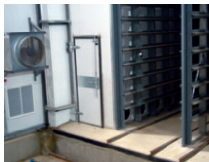
Sistema di ricircolo dell'aria per una maturazione ottimale dei prodotti
