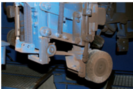
Le spazzole in acciaio rimuovono i residui di calcestruzzo dai fondelli.
