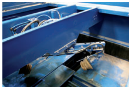
Le spugne per la lubrificazione dei fondelli cospargono l'olio in modo estremamente efficiente
