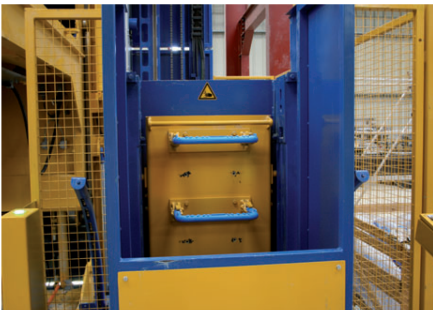
L'unità automatica per l'equipaggiamento delle sagome con gradini al marinaio si chiama stepmaster
