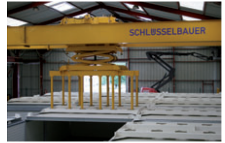
Facendo ruotare le barre mordenti è possibile coprire i vari elementi senza cambio utensile
