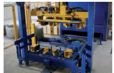
Una nuova produzione di Schlüsselbauer: L'unità di cambio rapido per le pinze meccaniche
