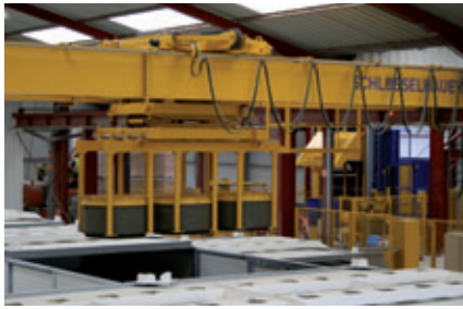
Stoccaggio degli anelli del pozzetto ancora freschi nei Kilns
