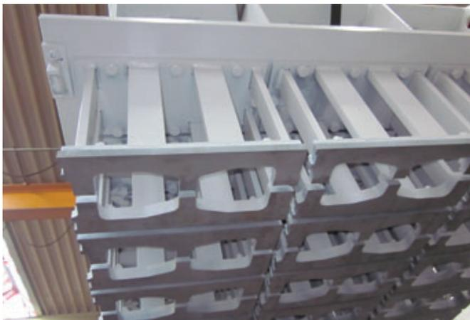
Collegamenti a vite precisi sui componenti costruttivi essenziali per la massima facilità di riparazione dello stampo.
