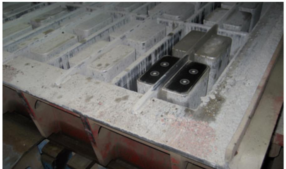
Le anime avvitati e sottoposti a cementazione sono stati collaudati nell'uso pratico.
