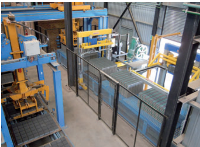
Transport de retour avec système de centrage des quatre côtés et dispositif de transport des paquets
