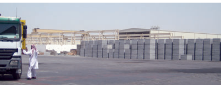
La capacité totale de Foresight Cement Industries L.L.C. à Abu Dhabi est de 100.000 blocs creux par jour.
