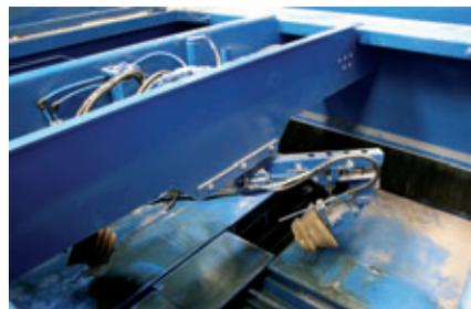
Die Schwämme zum Einölen der Untermuffen tragen das Öl äußerst effizient auf
