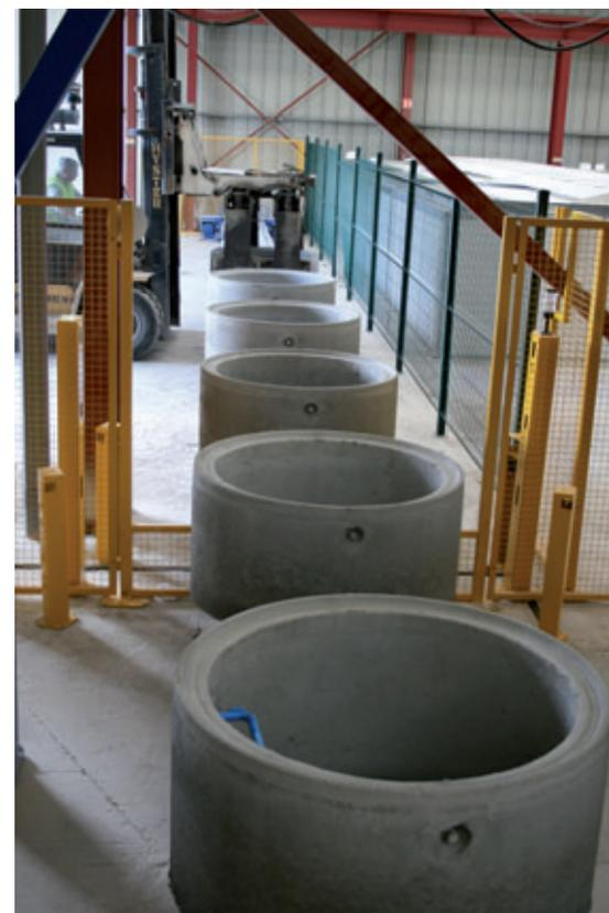
Die Übergabe an das Produktaustrageband. Die Betonbauteile verlassen in der Folgeschicht die Produktionshalle
