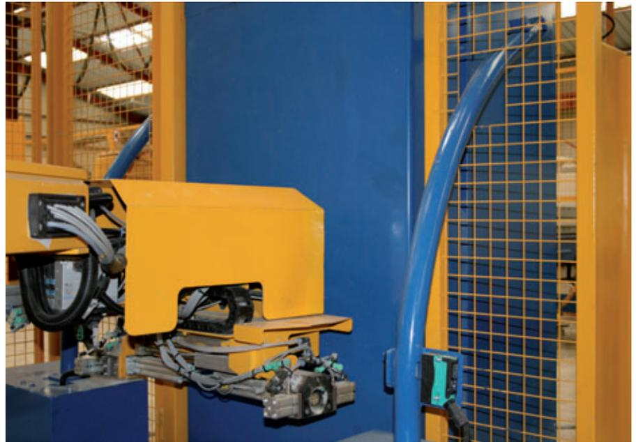
Der Einlegeroboter greift vollautomatisch zwei Anker und positioniert sie in die Form
