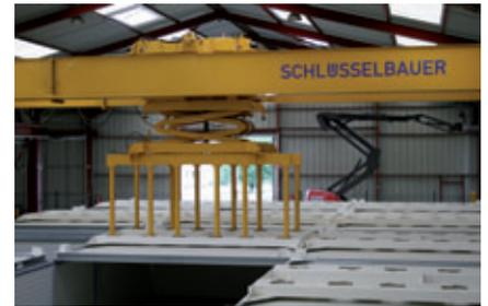
Durch Rotation der Greifstangen ist das Verfahren der Abdeckelemente ohne Werkzeugwechsel möglich
