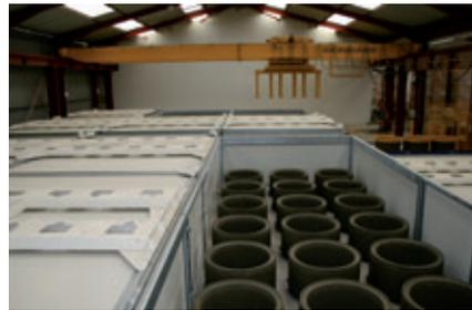
Die ausgehärteten Schachtringe kurz vor dem Abtransport durch den Kranroboter
