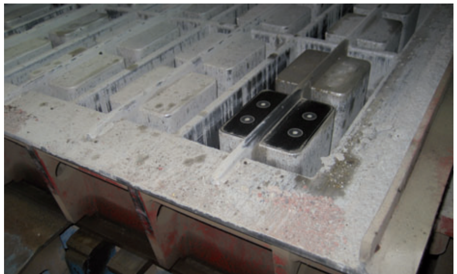
Geschraubte, ein-satzgehärtete Einzelkerne haben sich in der Praxis bewährt.
