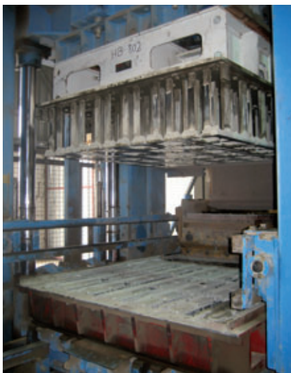
Foresight Cement Industries L.L.C. produziert den 8"-Hohlblockstein auf einer Masa XL 9.2
