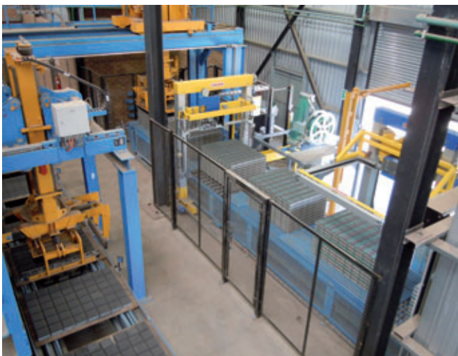
Rücktransport mit 4-Seiten-Zentrierung und Pakettransport
