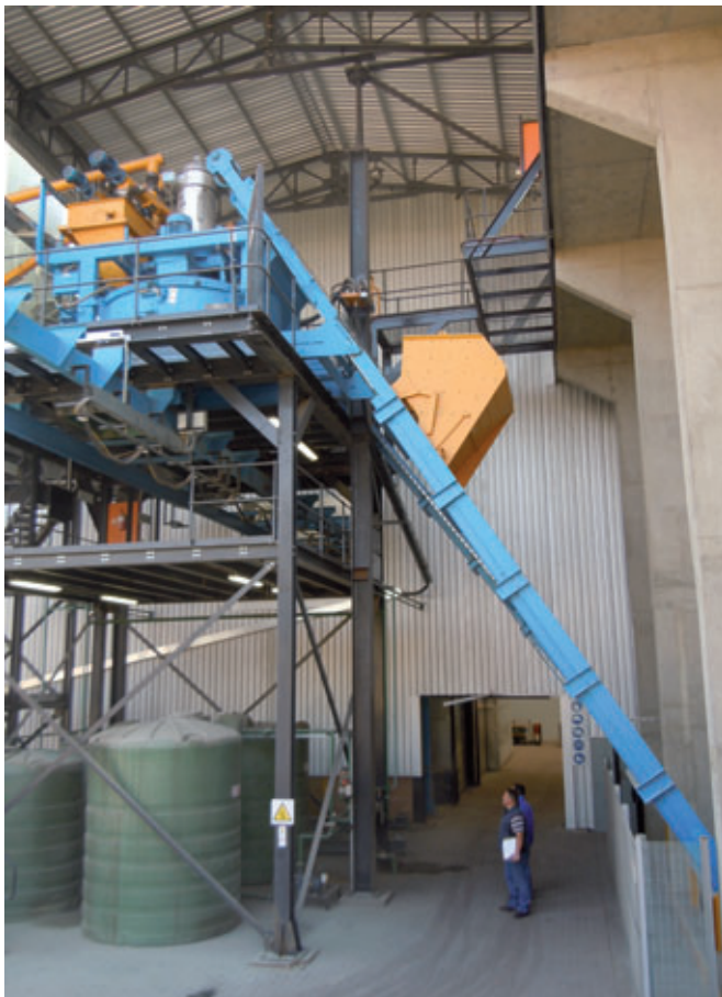
Mischergerüst mit Masa-Horizontalzwangsmischern PH 1500/2250 und PH 200/300
