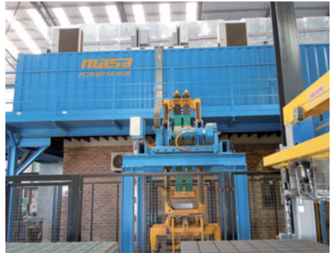
Powercontainer für Steuerungen
