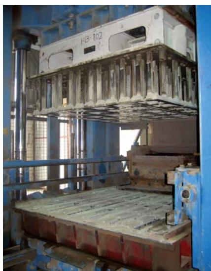
Foresight 混凝土工业有限责任公司采用玛莎 XL 9.2 生产 8” 空心砖
