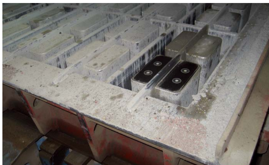
由螺栓固定的定型单芯的使用品质已在实践中得到证明
