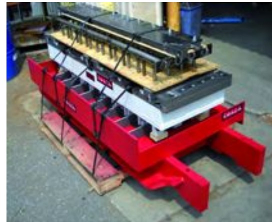
Форма Kobra для станка Besser SuperPac, готовая к отправке в Ferreteria Ochoa
