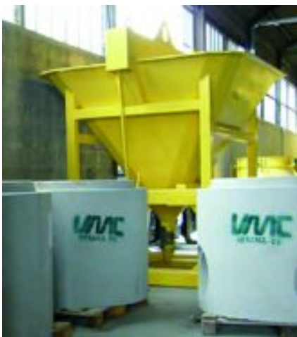
Данный бункер используется для заливки бетонной смеси класса C60/75 в формы Perfect
