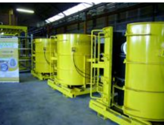
В этой адаптированной части цеха VMC весной 2011 года начала выпускать монолитные кольца с днищем Perfect
