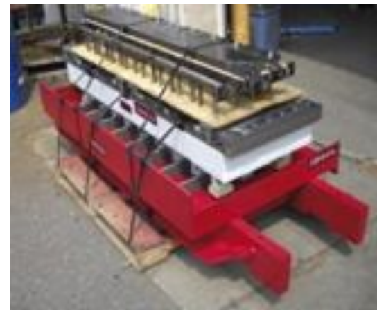
Forma firmy Kobra dla wibroprasy BesserSuperPac, gotowa do wysłania do zakładu firmy Ferreteria Ochoa.
