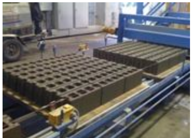
3-otworowe pustaki betonowe o szerokości 14 cm podczas produkcji.
