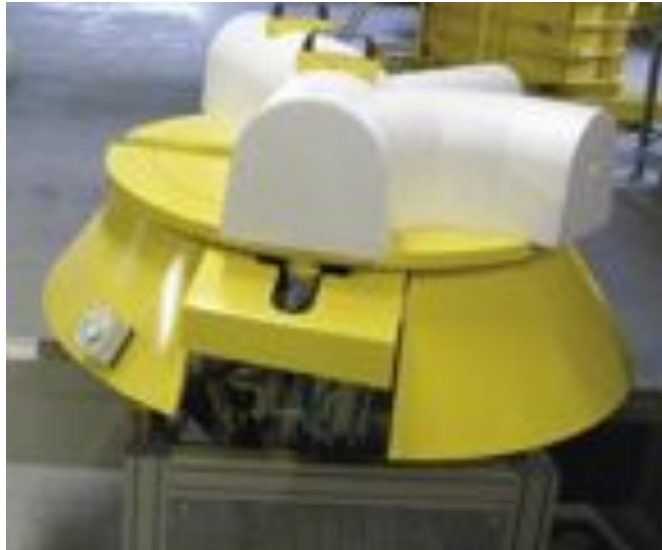
W VMC kształtki styropianowe przycinane są gorącym drutem dokładnie wg projektu. Na zdjęciu wycinarka formująca spocznik.
