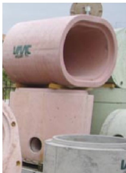
Unikatowa produkcja w VMC: owalne dennice (800/1200 mm).
