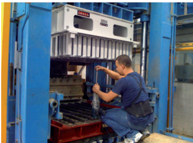
Stampo Kobra installato e pronto per la produzione
