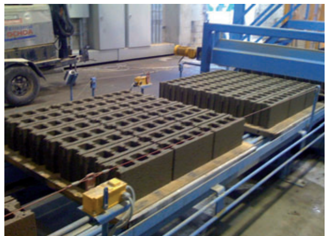
Blocco da 16 cm durante la lavorazione
