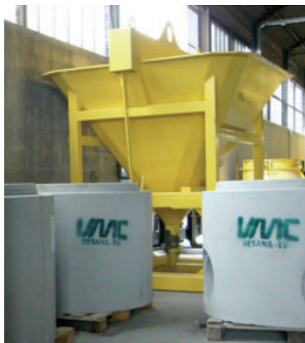
Con una benna per calcestruzzo viene versato negli stampi esclusivamente calcestruzzo della classe C60/75 per i prodotti Perfect.
