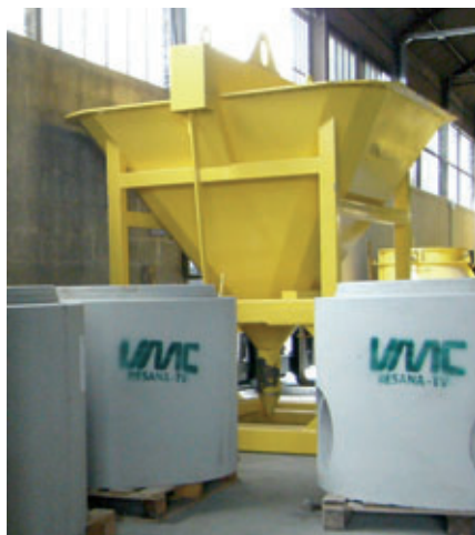
Avec une benne de béton, seul du béton de la catégorie C60/75 est versé dans les moules pour réaliser les produits Perfect.
