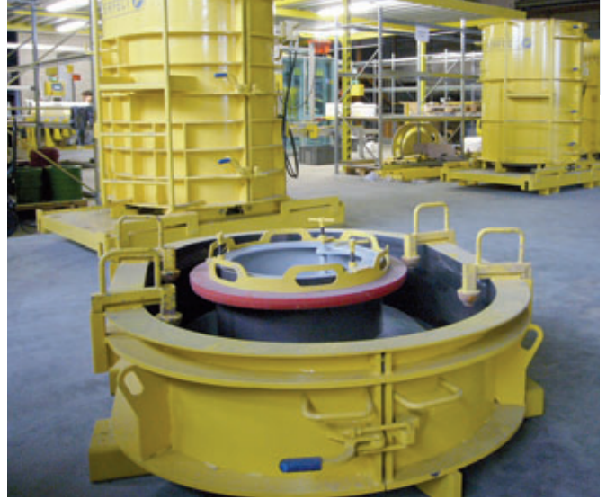
Auch Schachtabdeckungen werden im neuen Fertigungsverfahren hergestellt.
