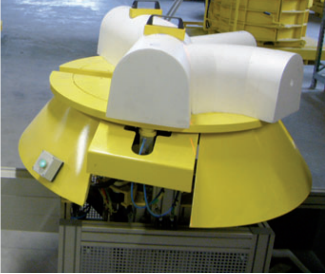
Auch bei VMC werden mit Heißdrahtsägen die materialsparenden EPS-Formteile passgenau nach Projektanforderungen zurecht geschnitten, im Bild die Säge zur Ausformung der Berme.
