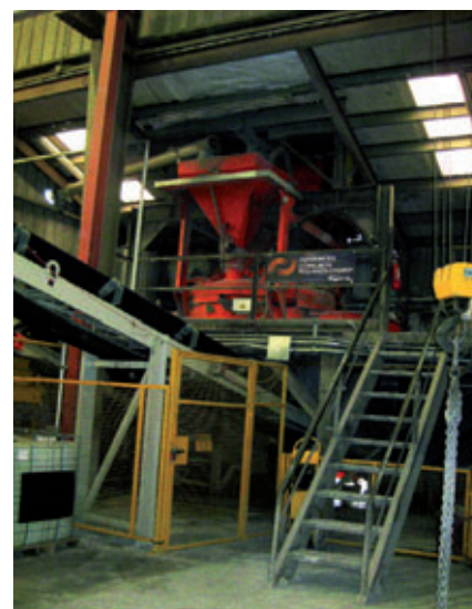
Смеситель ACT (Advanced Concrete Technology) вместимостью 1,7 м 3
