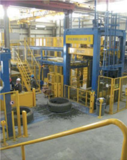
*Gli ingegneri della Schlüsselbauer hanno trasferito la zona manutenzione in un piano intermedio per poter installare l'impianto Exact1500 completamente automatico nel capannone di 2000 m<sup>2</sup> (22.000 ft<sup>2</sup>). "Schlüsselbauer ha dovuto adattare un pezzo di 5 m<sup>3</sup> a un imballaggio di 3 m<sup>3</sup>", sorride compiaciuto Dave Brinser.*
