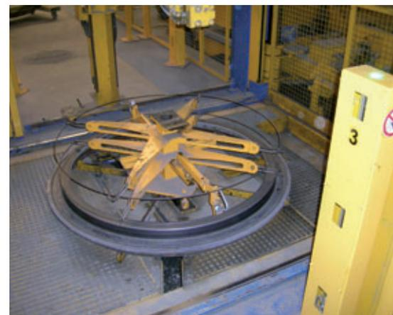
Les embases ne sont jamais transportées manuellement, ce qui évite les dommages de transport. Don Anger explique : « C'est essentiel, les dommages sur les embases ont une influence directe sur le produit fini et, par conséquent, sur l'étanchéité et l'ajustement des éléments entre eux. »
