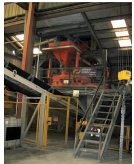
Bétonnière d'ACT (Advanced Concrete Technology) de 1,7 m<sup>3</sup> (2 yd<sup>3</sup>)
