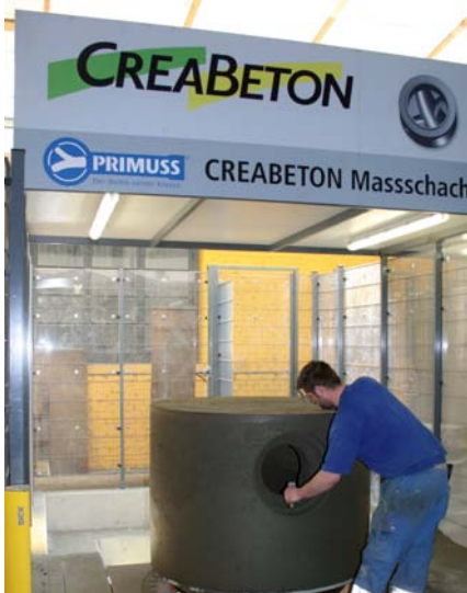
最后将管道连接口打扫干净
