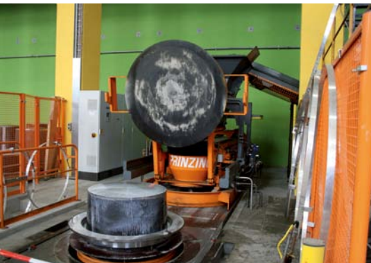
首先将下联轴器器和支盖装在 Atlas 设备上
