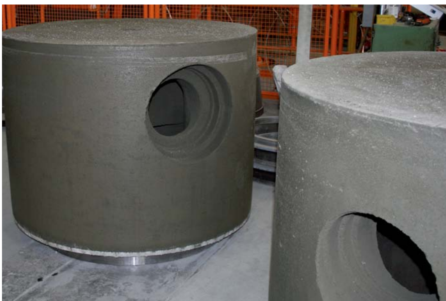
成块铣削的检查井井座在仓储区进行进一步固化
