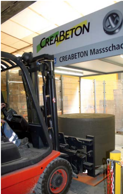
将混凝土检查井毛坯件放在工作站的锁紧环上
