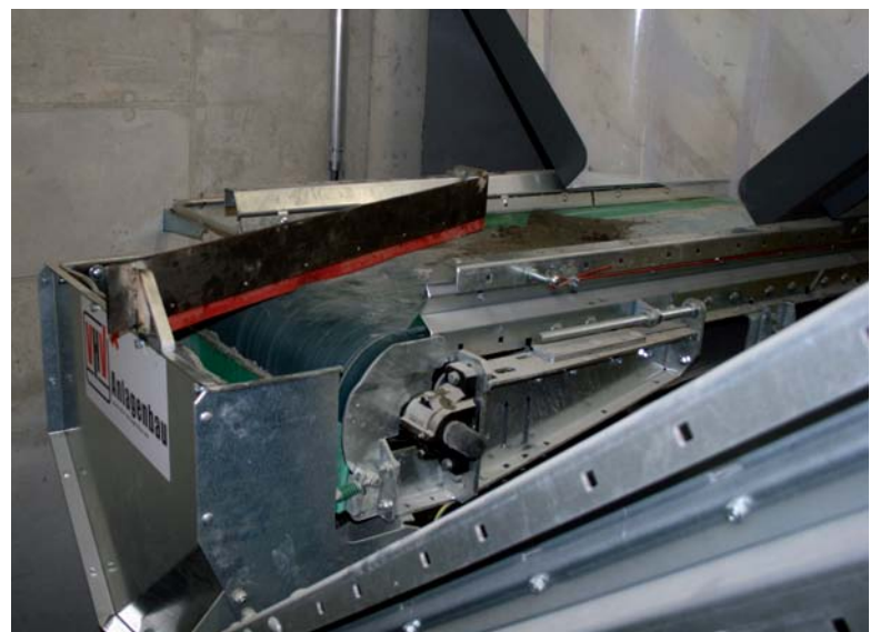
精密周全的输送带系统将铣削件输送出工作区
