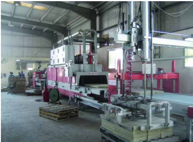
Установка для шлифовки поверхности с сохранением текстуры в цехе компании Transgulf
