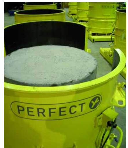
Стационарные формы Perfect на заводе Con Cast Pipe
