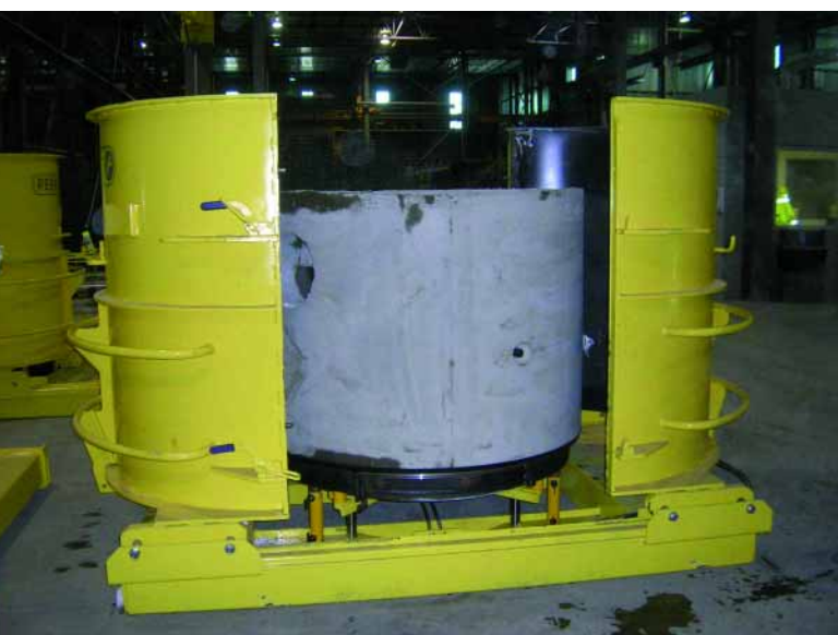
Затвердевшее монолитное кольцо с дном готово к распалубке
