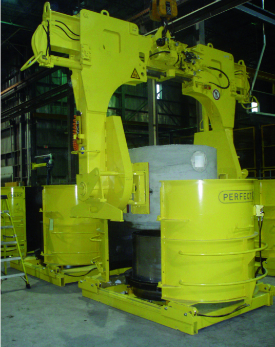
Поворотная траверса забирает изделие из формы
