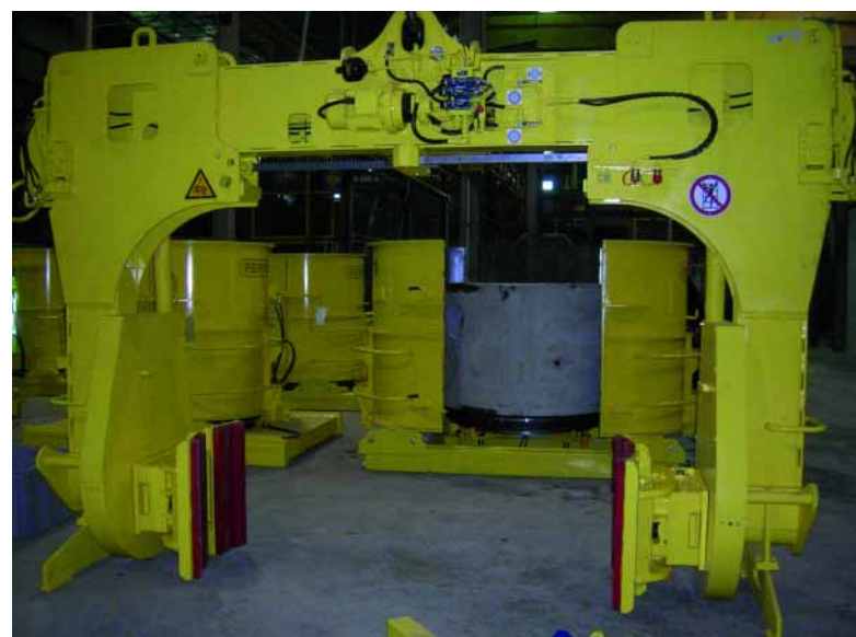
Для работы с затвердевшими изделиями используется поворотная крановая траверса
