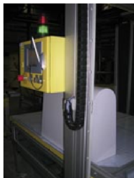
Kształtki styropianowe przycinane są dokładnie gorącym drutem.
