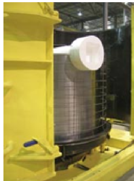
Model kinety i zbrojenie wkładane są do formy.
