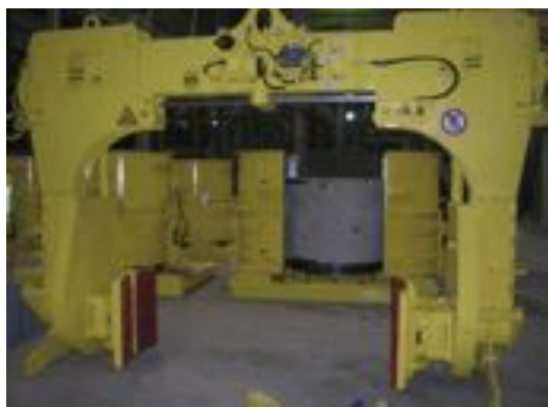
Do rozformowania, obracania i transportu wyrobu służy obrotnica podwieszona na suwnicy.
