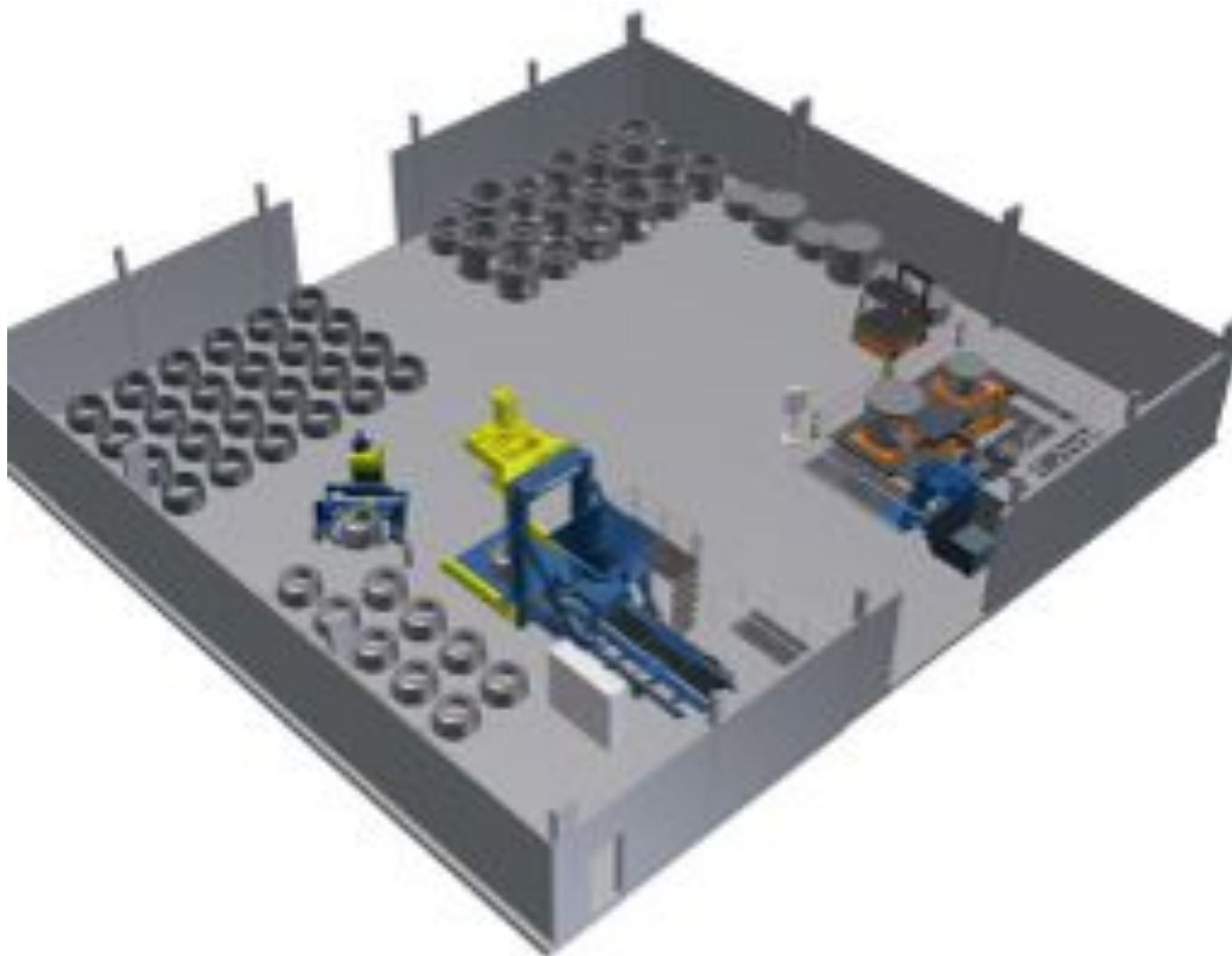
Linia technologiczna Tornado/Primuss do produkcji podstaw, kręgów, zwężek i pokryw studziennych.
