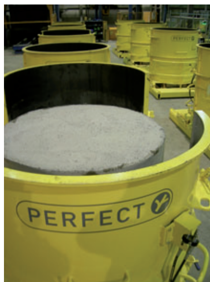
Stampi Perfect in una sistemazione statica in Con Cast Pipe.
