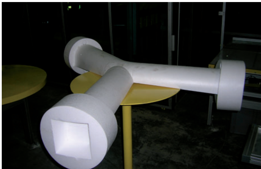
Configurazione completa di pozzetti come stampi negativi.
