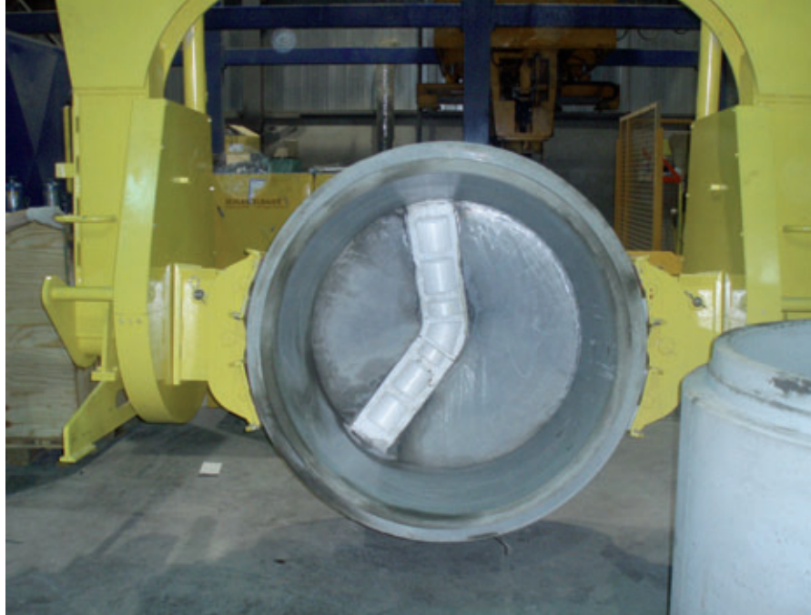
Tirante di ancoraggio colato per una manipolazione sicura dei prodotti in cantiere.
