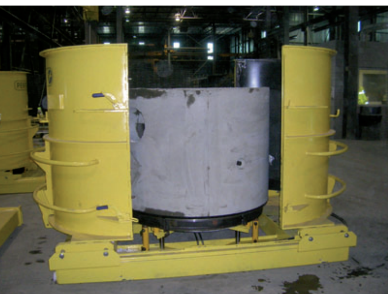
L'elemento di fondo monolitico indurito è pronto per la rimozione dalla cassaforma.
