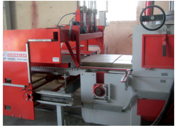
Uscita della macchina con dispositivo di spinta degli strati
