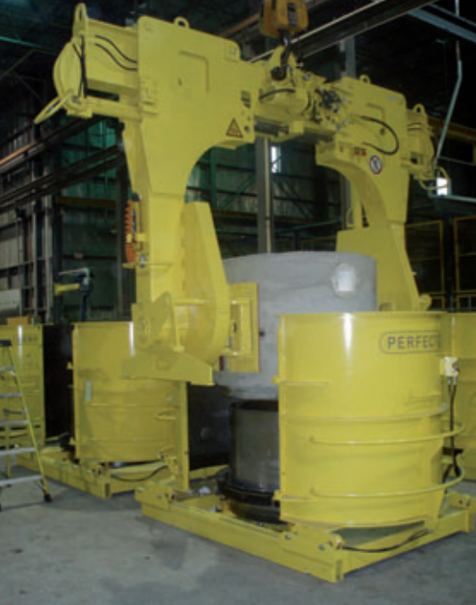
Die Wendetraverse entnimmt das Produkt aus der Form.
