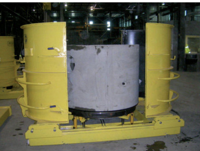
Das erhärtete monolithische Schachtunterteil ist bereit zum Entschalen.
