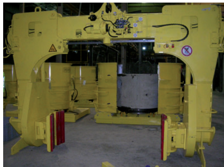
Für die Manipulation der erhärteten Produkte werden eine Wendetraverse und die bestehende Kranbahn eingesetzt.
