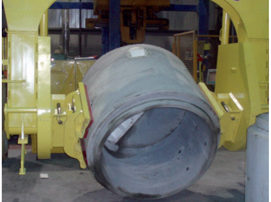
Entschalte Produkte werden in die spätere Einbauposition gedreht.
