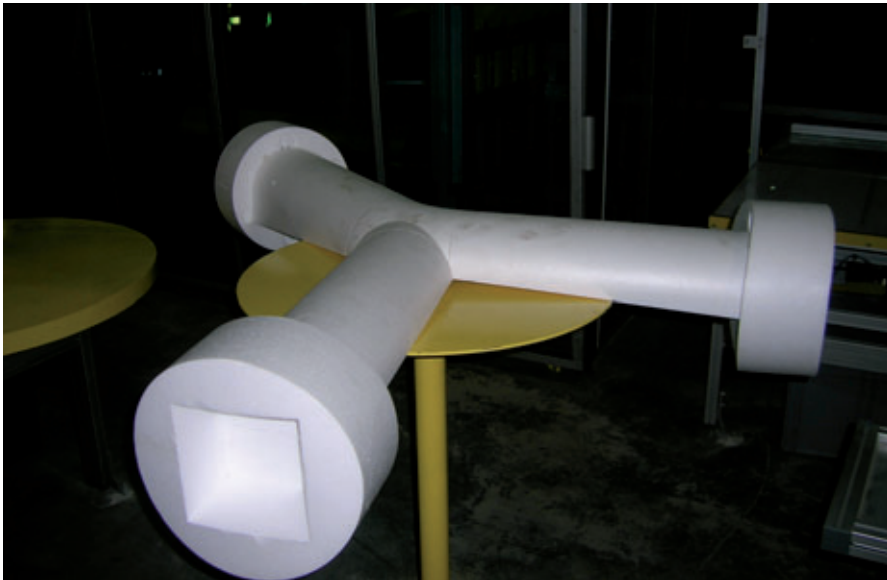
Eine vollständige Gerinnekonfiguration als Negativ-Form.
