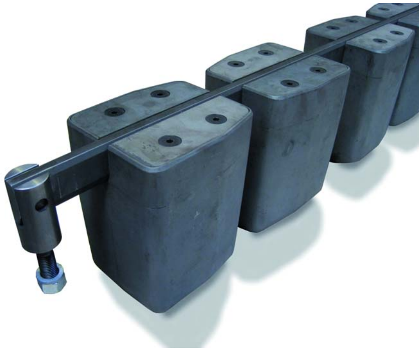
Рис. 3: Новая конструкция для стандартных пустотных камней с закаленными по технологии «carb» стальными пустообразователями на индивидуальных винтовых соединениях
