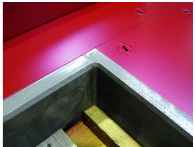
Рис. 5: Грань формы с новаторскими одиночными бортами со стандартной твердостью 68 HRC
