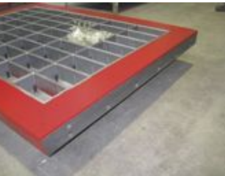
1: Dolna część formy »Module2« w postaci dostarczanej do klienta w przypadku samodzielnego montażu kołnierzy gwintowanych.
