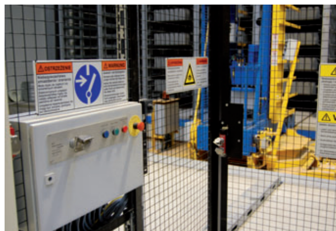
I sistemi di chiusura per l'apertura sicura delle porte – in combinazione con il terminale di consenso in loco per la sicurezza degli impianti
