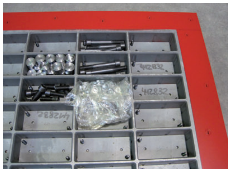
Fig. 2 : partie inférieure du moule « Moduline2 » avec empreintes livrées séparément et kit de fixation pour les brides filetées
