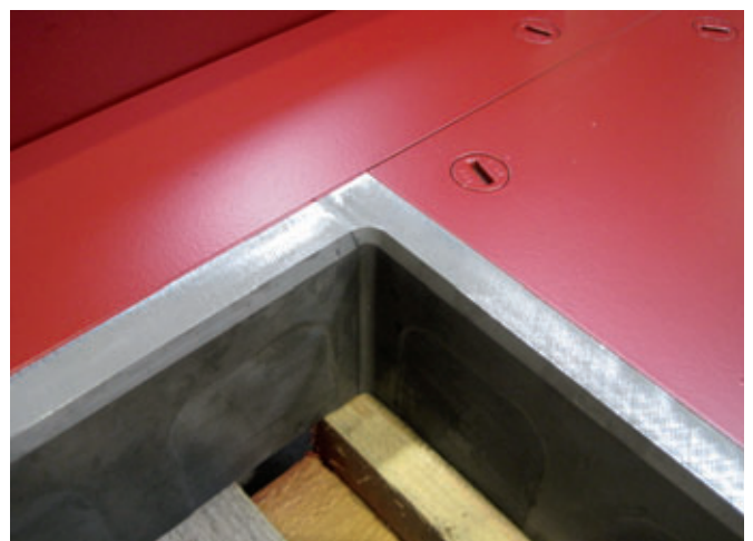
Fig. 5 : angle de moule avec parois innovatrices de dureté standard 68 HRC
