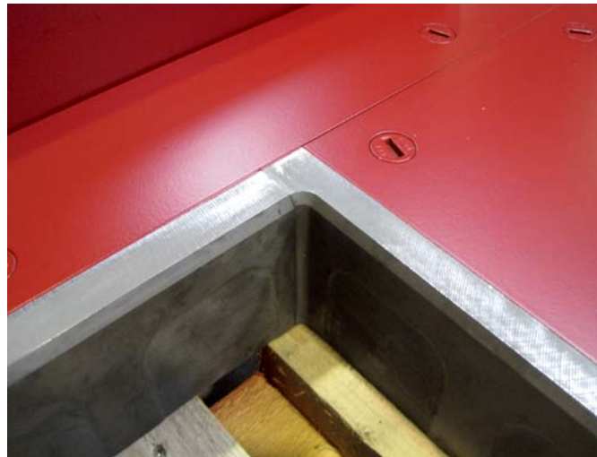
图 5: 标准硬度 68HRC 的创新型单壁的模具角
