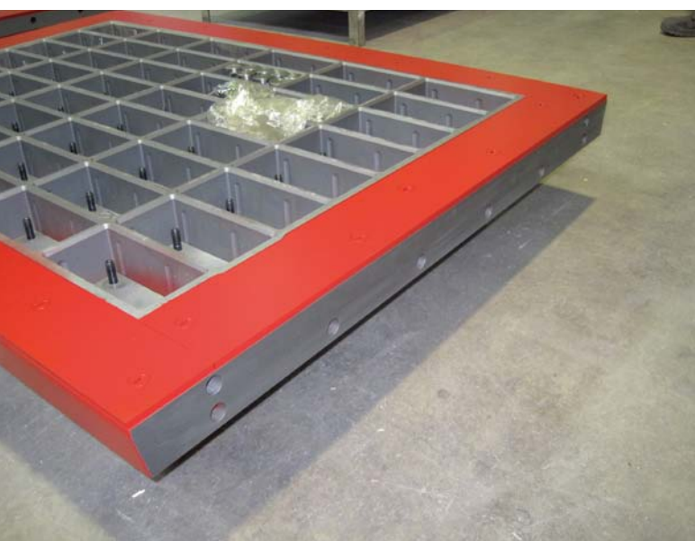
图1：交货时“Moduline2”模具下半部带有用户可自行组装的螺栓配件
