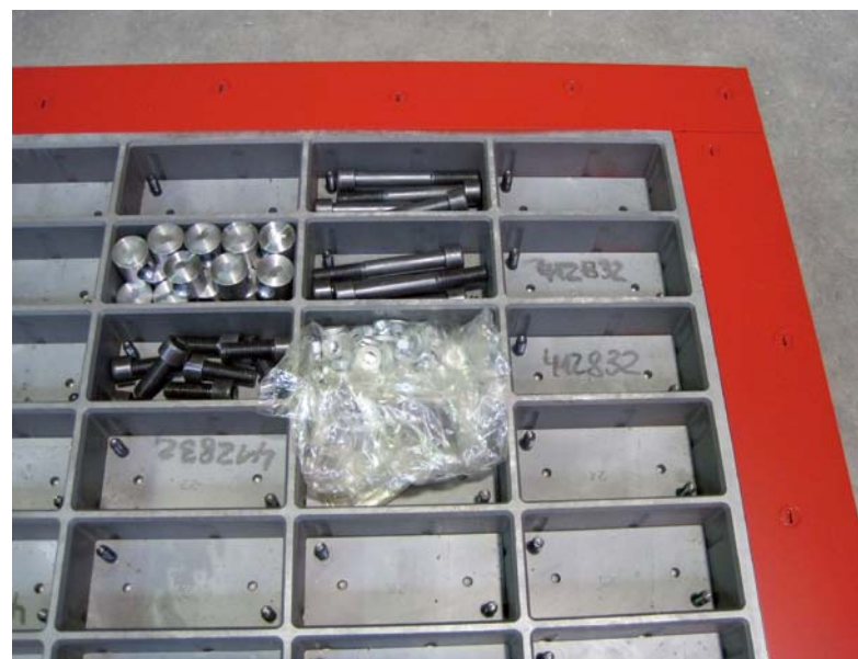
图2：“Moduline2”模具下半部分别带有压板和安装用螺栓套件
