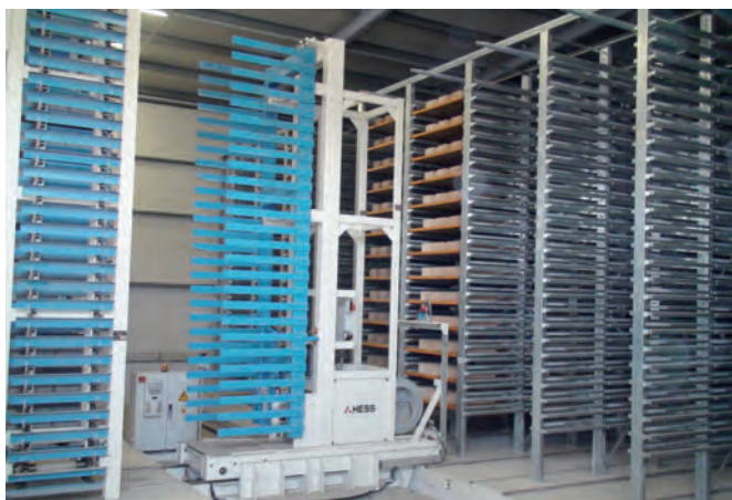
Транспортный узел с 26 уровнями и поворотной платформой
