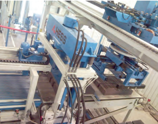
Отформованные бетонные камни доставляются на транспортной паллете к серво-пакетировщику, пакетировщик принимает их и кладет их на сплиттерную линию
