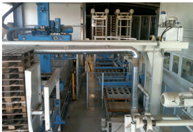
Сухая зона с укладчиком бумаги и пленки, горизонтальная обвязка
