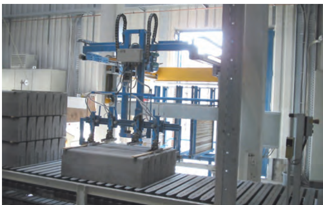
Транспортировщик технологических поддонов, курсирующий между влажной и сухой зонами, буферная установка
