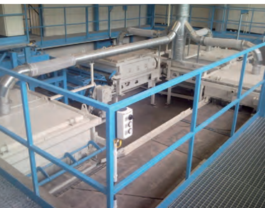
Tumbler Master с четырьмя станциями и устройством для переворота слоев. Общий вид
