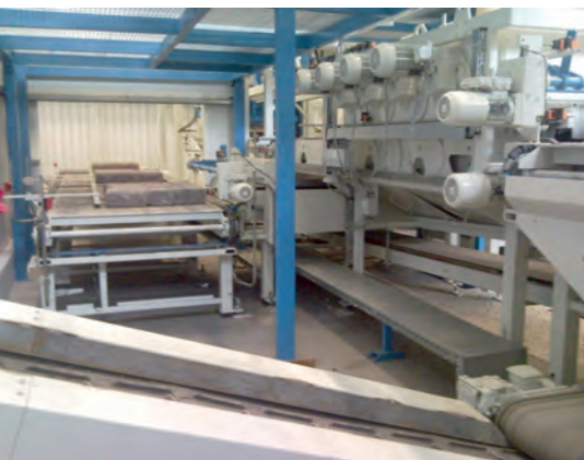
Циркулирующие транспортеры обеспечивают автоматическую утилизацию остатков производства
