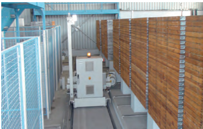
Автоматическое устройство укладки планок, рассчитанное на 2 или 4 планки
