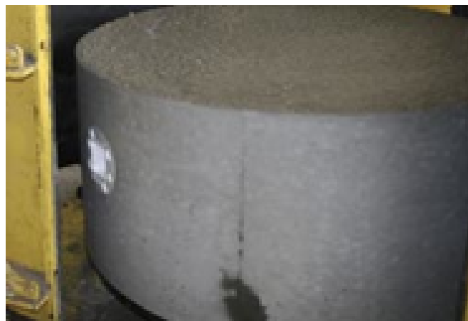
Podstawa studni po otwarciu formy.
