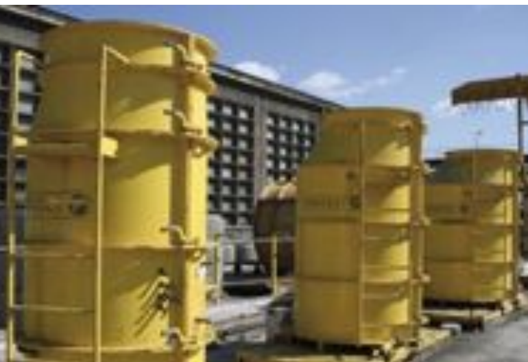
Trzy nowe formy do produkcji kręgozewęzek o wysokości do 2 350 mm i średnicach DN 1000, DN 1200 i DN 1500.
