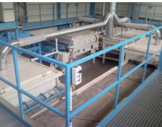
Panoramica Tumblemaster con 4 stazioni di burattatura e dispositivo voltastrati blocchi
