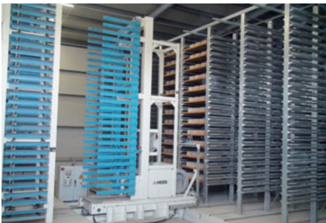
Carrello portaforche a 26 piani e dispositivo di rotazione
