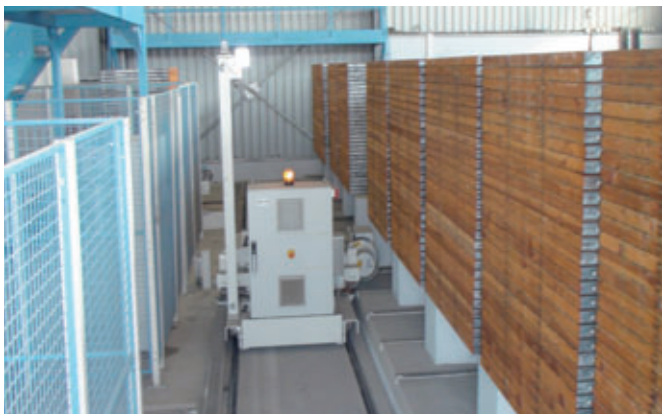
Dispositivo inserimento di 2 o 4 listelli
