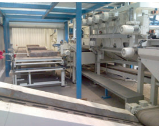
Nastri per la raccolta rifiuti circolanti provvedono a smaltire automaticamente i residui
