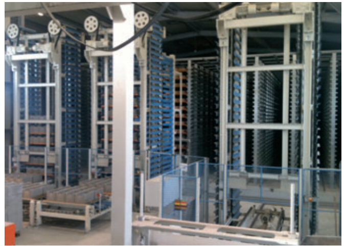
A sinistra i due dispositivi di abbassamento e a destra quelli di sollevamento
