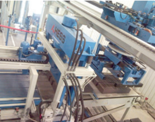
I blocchi grezzi vengono portati all'impacchettatrice servoassistita su un pallet per il trasporto, l'impacchettatrice preleva un intero strato di blocchi per volta e lo posiziona sulla Splitline
