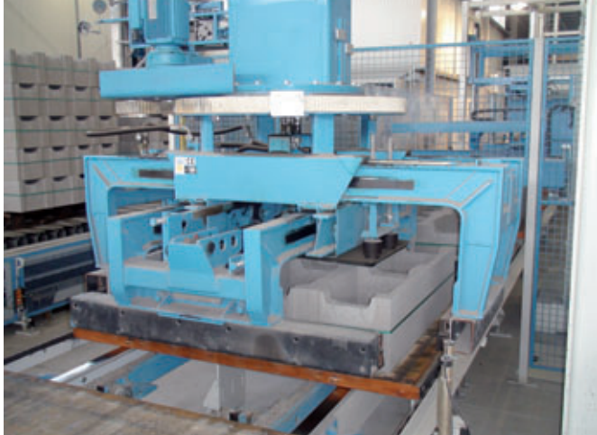
Impacchettatrice con servomotori e cinghie dentate
