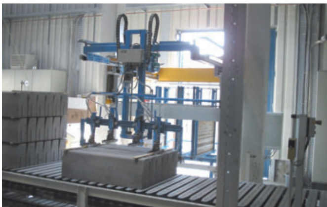
Carrello transfer per catasta tavole tra lato dell'umido e lato del secco oppure deposito provvisorio tavole
